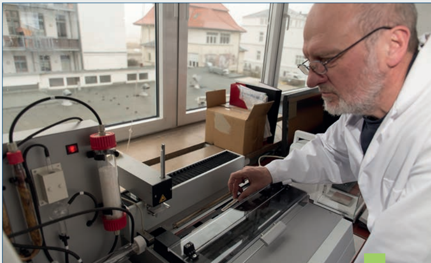
Thomas Leipe bestimmt am neuen Elementaranalysator den Kohlenstoffgehalt in Sedimentproben. / Thomas Leipe determines the carbon content of sediment samples with the new elemental analyzer. (Foto / Source: S. Kube/IOW)
