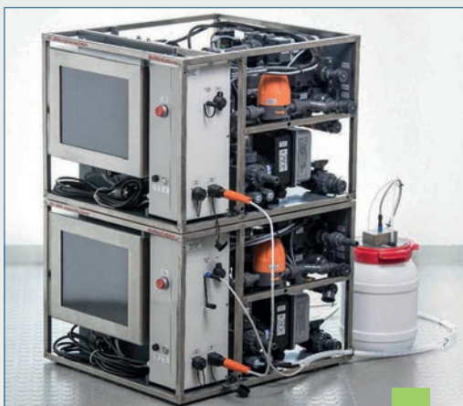
Die paarweise Anordnung der Messgeräte im Mini-Messcontainer garantiert kontinuierliche Messungen physikalischer Parameter des Oberflächenwassers. / The pair-wise arrangement of the measuring instruments in the monitoringbox guarantees continuous measurements of physical parameters of the surface water. (Foto / Source: IOW)
