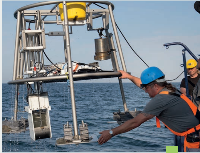
Testeinsatz des am IOW für den Einsatz auf sandigen Sedimenten konzipierten Landers mit benthischer Kammer zur in-situ Messung hydro-chemischer Parameter und einem Spritzensystem zur Entnahme von Wasserproben in Zeitserien. / Test of the new IOW chamber-lander. This system facilitates the investigation of hydro-chemical parameters in permeable sandy sediments and includes a syringe system to collect water samples at a time series. (Foto / Source: S. Kube/IOW)
